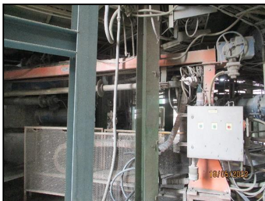
ภาพที่ 2.11 การติดตั้ง Kiln inlet gas analyzer
