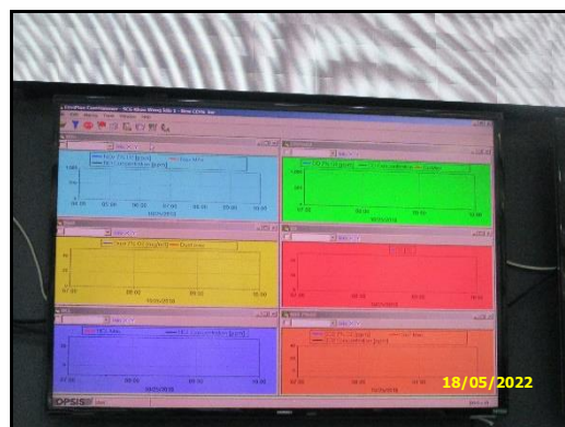
ภาพที่ 2.5 จอแสดงผลการติดตั้งเครื่องตรวจวัดฝุ่นที่ระบายออกจากปล่องหม้อเผา (CEMS) เพื่อการควบคุมปริมาณฝุ่นให้อยู่ในเกณฑ์ที่กำหนด ภายในห้อง ควบคุมการผลิต
