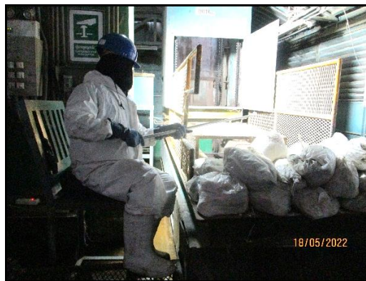
ภาพที่ 2.35 การป้องกันกากของเสียเข้า Riser Pipe
